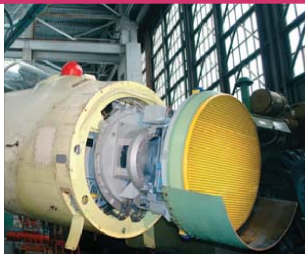
Радар ирбис-Е – јасно је видљив зглоб механичког покретања антене за проширење угла претраживања по азимуту
